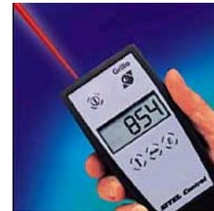
Sono sensori **non invasivi, costosi, e molto stabili** che permettono di misurare **anche temperature elevate**; la loro sensibilità è più accentuata alle alte temperature.
