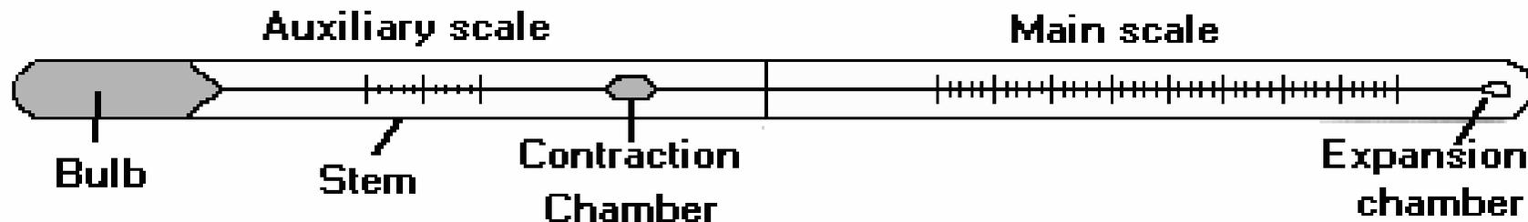
Per esempio il **mercurio (Hg)** è allo stato liquido nell'intervallo di temperature tra  $-38\text{ }^{\circ}\text{C}$  e  $+356\text{ }^{\circ}\text{C}$  e la sua **dilatazione (lineare con la temperatura)** può essere impiegata per realizzare un termometro a mercurio.
