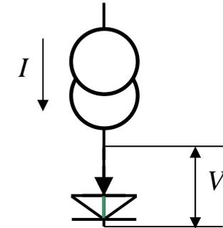
In un **diodo** la relazione corrente-tensione,  $I = I_0 \exp(V / V_T) = I_0 \exp(qV / kT)$ , porta a una relazione tensione-temperatura del tipo:  $V = \frac{nkT}{q} \ln\left(\frac{I}{I_0}\right)$
