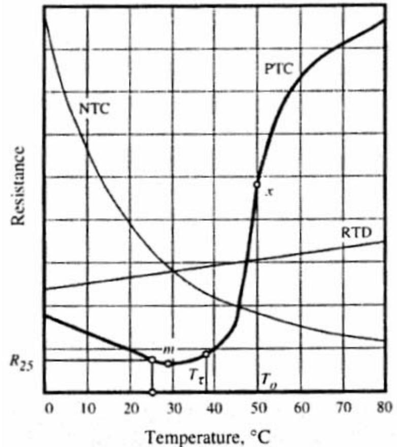
I termistori PTC hanno un intervallo di funzionamento ristretto e sono usati per la **protezione da sovraccarichi e da surriscaldamento** (il loro valore di resistenza "scatta" da un valore basso a un valore alto per  $T$  che supera  $T_0 > T_\tau$ ).
