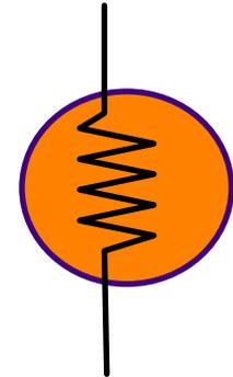
In generale la funzione di trasferimento di un **termistore NTC** può essere approssimata da una funzione esponenziale a quattro parametri, piuttosto complessa, anche se molto spesso si ricorre a un'espressione semplificata:
